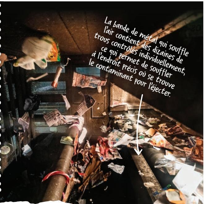
La bande de métal qui souffle l'air contient des dizaines de trous contrôlés individuellement, ce qui permet de souffler à l'endroit précis où se trouve le contaminant pour l'éjecter.
